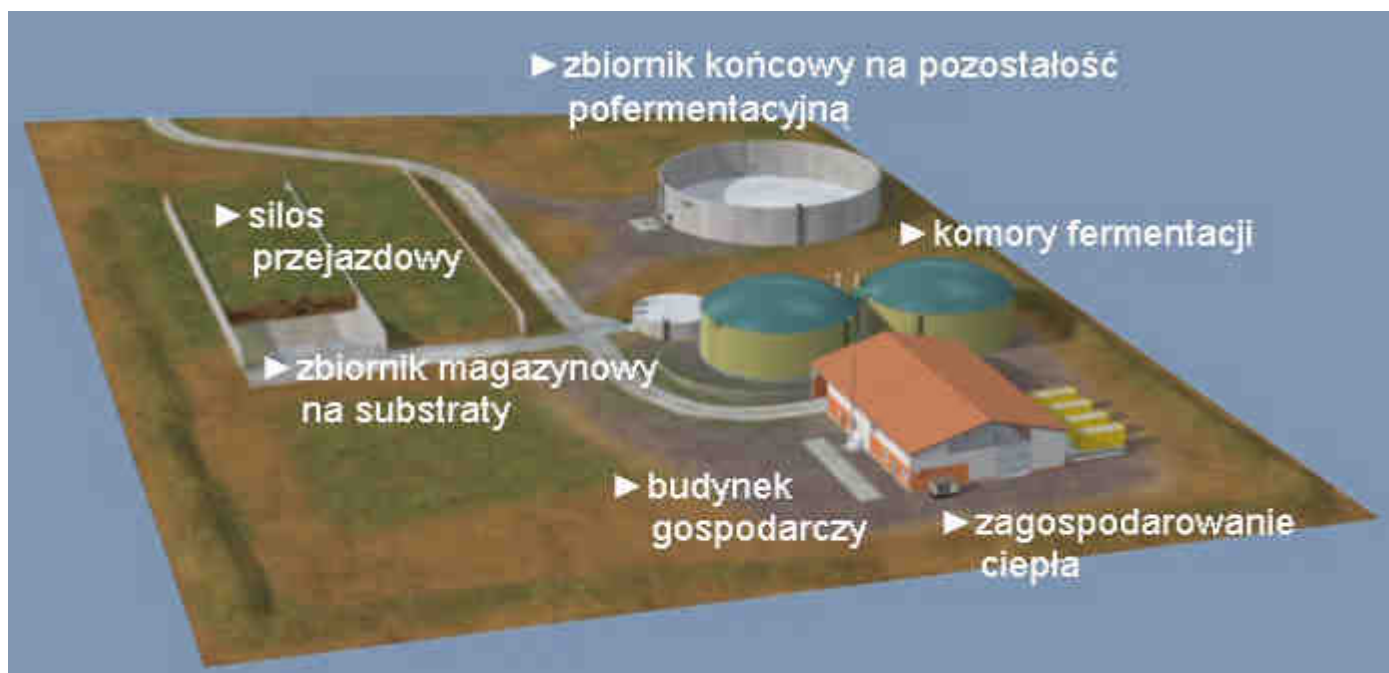
Ilustracja 1 Biogazownia rolnicza firmy EnerCess GmbH
